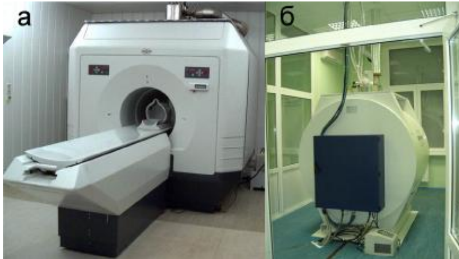
Рис. 1. Магнитно-резонансные томографы, на которых проводились диссертационные эксперименты: а) Bruker Tomikon S-50 с полем 0.5 Тл и б) Bruker BioSpec 70/30 с полем 7 Тл.
