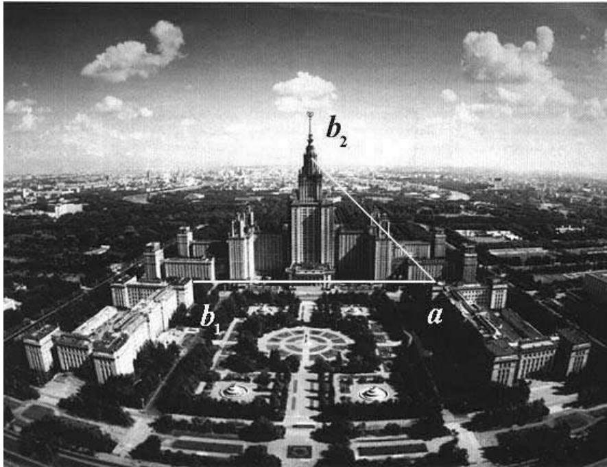
Рис. 3. Расположение приземных лазерных локационных трасс (белые линии) в районе Московского государственного университета им. М.В. Ломоносова. a – входная и выходная апертуры; b_1 , b_2 – отражающие зеркала. ab_1 – горизонтальная, ab_2 – наклонная трассы.
