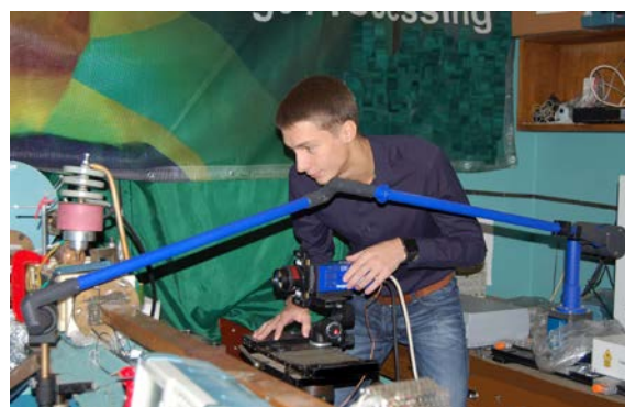
Студент Дмитрий Наумов налаживает аппаратуру – лазерный комплекс фирмы LaVision для диагностики импульсных разрядов при воздействии ударных волн
