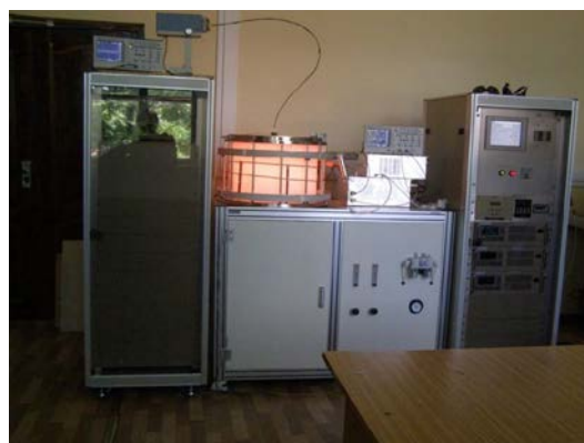
Установка для осаждения плазменно-полимерного гидрофильного наноструктурированного покрытия
