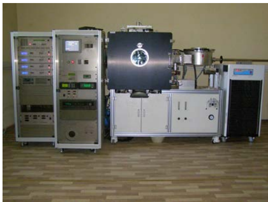
Вакуумная установка для легирования тонких пленок, имплантации ионов и создания наноструктурированных металлических покрытий
