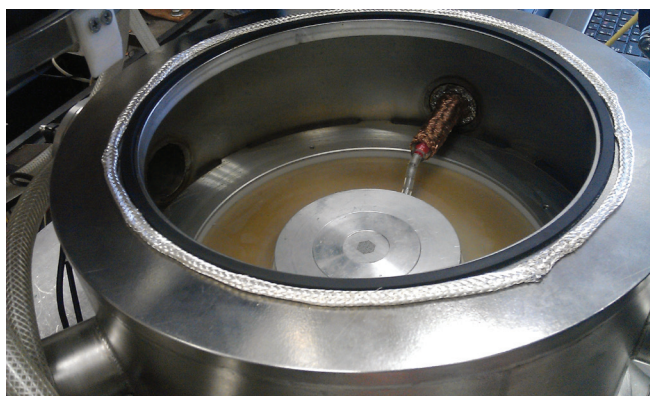
«Настоящий» датчик для измерения энергетического спектра ионов.
