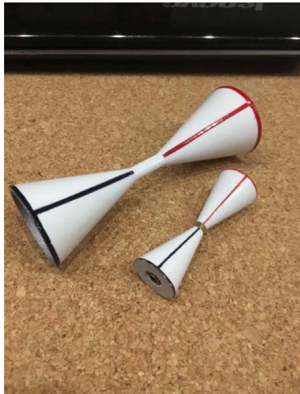
Рис. 1. Устройства демонстрации стробоскопического эффекта.
