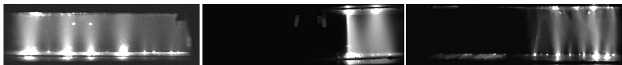
Рис. 1. Свечение разряда в невозмущенном газе (слева), перед ударной волной (в середине), перед областью контактного перехода (справа)
