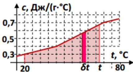
Поэтому  $Q_-$  можно вычислить (см. рисунок) как площадь под графиком удельной теплоемкости на участке от начальной до конечной температуры жидкости, умноженную на массу жидкости. Как видно, для нагрева жидкости от  $t_1 = 20^\circ\text{C}$  до температуры  $40^\circ\text{C}$  потребуется количество теплоты
