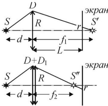
добавочной линзы;  $d$  – расстояние от диапозитива до объектива;  $f_1$  и  $f_2$  – расстояния от объектива до изображения;  $L$  – расстояние от объектива до экрана;  $R$  – радиус линзы и  $r$  – радиус пятна на экране. Из верхней и нижней частей рисунка видно, что  $\frac{r}{R} = \frac{f_1 - L}{f_1} = \frac{L - f_2}{f_2}$ . Отсюда  $\frac{1}{f_1} + \frac{1}{f_2} = \frac{2}{L}$ . Формула тонкой
