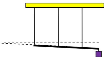
деформация есть точно полусумма деформаций этих нитей, или  $2x_2 = x_1 + x_3$  (см. рисунок, на котором для наглядности деформации показаны увеличенными). Нити
