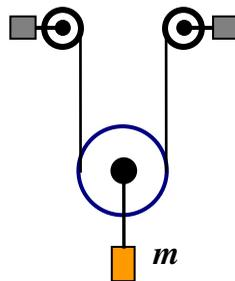
**Ответ на вопрос:** Работа сторонних сил источника с ЭДС  $\mathcal{E}$  идет на механическую работу двигателя, перемещающего груз силой  $F$  со скоростью  $v$ , и на компенсацию тепловых потерь на сопротивлении контура обмотки ротора  $R$ , то есть  $\mathcal{E} \cdot I = RI^2 + F \cdot v$ . Если  $F = kI$ , то  $v = \frac{\mathcal{E} - RI}{k}$ , то есть установившаяся скорость больше при меньшем токе. Значит, большая скорость у первого груза.
