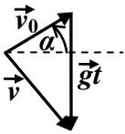
$\vec{v}(t) = \vec{v}_0 + \vec{g}t$ . Заметим, что угол между векторами  $\vec{v}_0$  и  $\vec{g}$  равен  $90^\circ - \alpha$  (см. рисунок). После возведения этого равенства в квадрат получаем:
