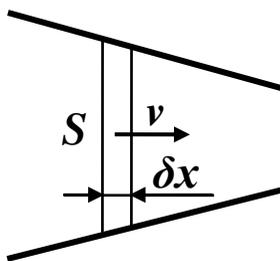
с очень малой толщиной  $\delta x$  и поперечным сечением  $S$  (ввиду малости толщины пренебрегаем его изменением). Масса этого слоя  $\delta m = \rho S \delta x$ , и увеличение его кинетической энергии при сдвиге в «соседнее» положение равно
