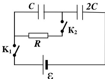
**Возможное решение:** После замыкания  $K_1$  батарея конденсаторов общей емкостью  $C_{\text{общ}} = \frac{2C \cdot C}{2C + C} = \frac{2}{3}C$  заряжается от источника до напряжения  $\mathcal{E}$ . Заряд каждого из конденсаторов  $q = \frac{2}{3}C \mathcal{E} = 1000 \text{ мкКл}$ . На этой стадии ток через резистор не течет, и тепло в нем не выделяется.
