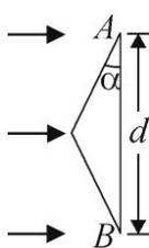
4. На равнобедренную стеклянную призму падает широкий параллельный пучок света, перпендикулярный грани  $AB$ , ширина которой  $d = 5 \text{ см}$ . На каком расстоянии  $L$  от грани  $AB$  преломленный призмой свет разделится на два не перекрывающихся пучка? Показатель преломления стекла  $n = 1,5$ , угол при основании призмы  $\alpha = 0,1 \text{ рад}$ . При расчетах учтите, что для малых углов, заданных в радианах,  $\text{tg } \alpha \approx \sin \alpha \approx \alpha$ .
