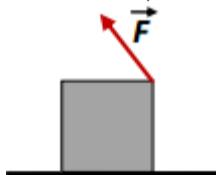
**Комментарий:** Пусть  $\alpha$  – угол наклона линии действия силы  $\vec{F}$  к горизонтали. Тогда требование отсутствия скольжения куба означает, что сила трения  $F_{mp} = F \cos(\alpha)$ , а сила нормальной реакции поверхности  $N = mg - F \sin(\alpha)$ , и при этом  $F_{mp} \leq \mu N$ . Значит,  $\frac{mg}{F} \geq \frac{\cos(\alpha) + \mu \sin(\alpha)}{\mu}$ . С другой
