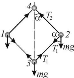
2 и 3 на вертикальную координатную ось имеют вид:  $T_2 \cos \alpha = T_1 \cos \alpha + mg$  и  $2T_1 \cos \alpha = mg$ . Проекция уравнения движения груза 2 на горизонтальную координатную ось есть  $\frac{mv^2}{l \sin \alpha} = T_2 \sin \alpha + T_1 \sin \alpha$ , где  $v$  – линейная скорость груза 2. Из записанных
