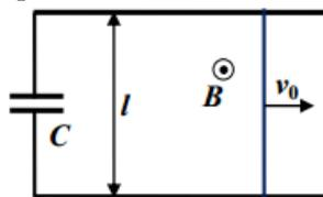
и опускает на горизонтальные сверхпроводящие шины проводящую перемычку длины  $l = 1,5$  м, замыкая цепь заряда конденсатора. Шины и перемычка находятся в вертикальном
