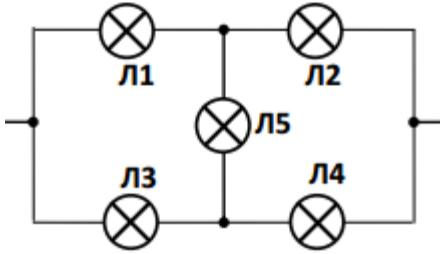
**Комментарий:** Ясно, что ток через  $L5$  не течет, поэтому  $I_2 = I_1$  и  $I_4 = I_3$ . Кроме того, напряжение на  $L5$  равно нулю, поэтому  $U_3 = U_1$  и  $U_4 = U_2$ . Лампа 4 работает в номинальном режиме, поэтому ее номинальная мощность  $P_4 = U_4 I_4 = U_2 I_3 = \frac{U_2 I_2}{I_1} \frac{U_3 I_3}{U_1} = \frac{P_2 P_3}{P_1}$ .
