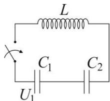
конденсатор емкостью  $C_2 = 10^{-6}$  Ф разряжен. Известно, что в процессе колебаний, возникающих в цепи после замыкания ключа, амплитуда напряжения на конденсаторе  $C_2$  оказалась равной
