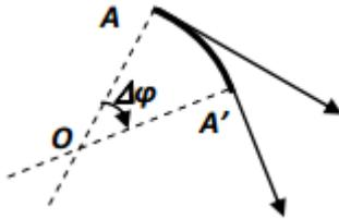
участок траектории всегда можно представить как дугу окружности, на которой вектор скорости поворачивается на тот же угол. Действительно, если на малом участке траектории длиной  $\Delta l$
