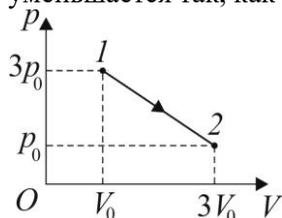
рисунок). Определите максимальное значение  $U_{\max}$  внутренней энергии газа в процессе  $1-2$ . Начальные значения объёма и давления газа равны  $V_0 = 0,1 \text{ м}^3$  и  $p_0 = 5 \cdot 10^4 \text{ Па}$  соответственно.
