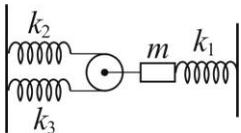
соответственно, соединённых так, как показано на рисунке. Центр масс груза лежит на одной горизонтали с прикрепленной к нему нитью и осью пружины  $k_1$ . В положении равновесия все пружины растянуты. Считая, что нити все время остаются натянутыми, определите круговую частоту  $\omega$  малых гармонических колебаний груза. Ответ приведите в рад/с, округлив до целых.
