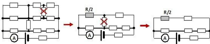
включен между точками с одинаковым потенциалом («правый верхний» угол схемы – сбалансированный мост). Поэтому его можно убрать из схемы без изменения токов в остальных ее элементах. После этого в верхней части образуются две пары параллельно соединенных участков, которые можно заменить на резисторы с сопротивлениями  $\frac{R}{2}$  и  $R$ . Тогда в схеме
