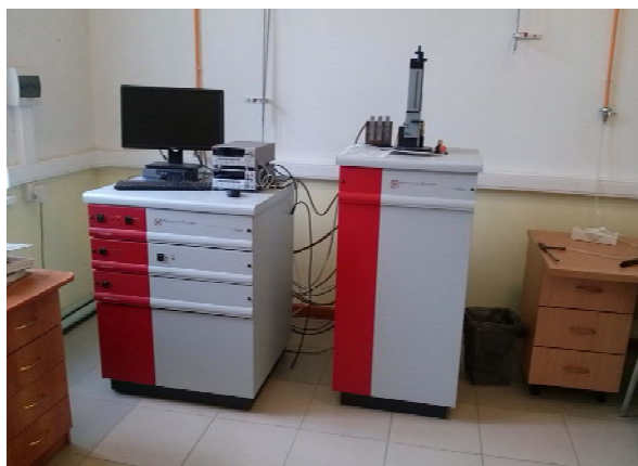
Установка для исследования магнитных свойств (MPMS), Quantum Design) в диапазоне температур 0.3-300 K.
