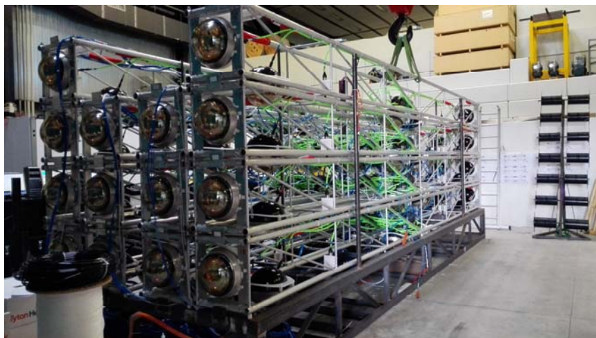
Основной элемент (башня) нейтринного телескопа KM3Net, собранная и готовая к погружению (ноябрь 2014 г.) в данном проекте принимают участие сотрудники, аспиранты и студенты кафедры
