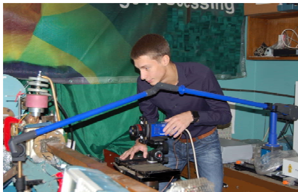
Студент Дмитрий Наумов настраивает аппаратуру – лазерный комплекс фирмы LaVision для диагностики импульсных разрядов при воздействии ударных волн
