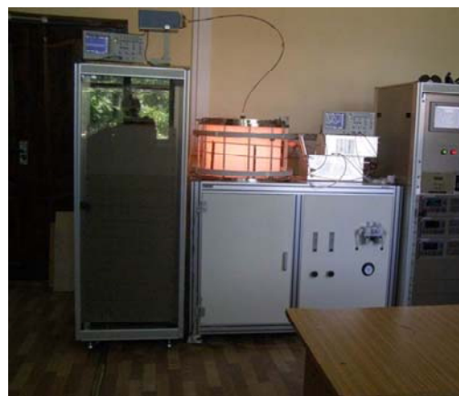
Установка для осаждения плазменно-полимерного гидрофильного наноструктурированного покрытия
