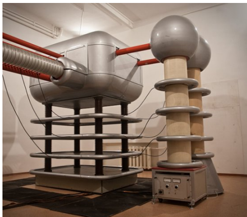
Ускорительный комплекс на энергии ионов до 500 кэВ
