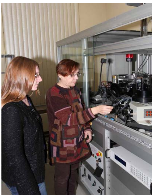
Профессор, д.ф.-м.н. Казей З.А. и студентка 4 курса Вялых Д. монтируют образец для исследования на автоматизированном дифрактометре STADIIP с низкотемпературной приставкой замкнутого цикла, работающей в области температур 6...300 К.
