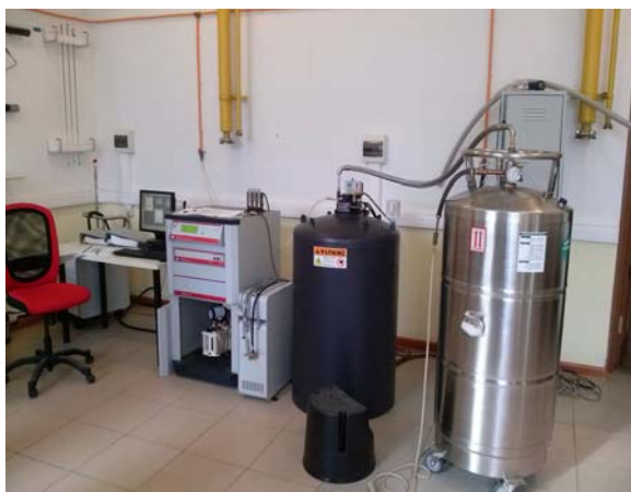
Установка для исследования термодинамических свойств (Physical Property Measuring System (PPMS), Quantum Design) в диапазоне температур 0.3-300 K.
