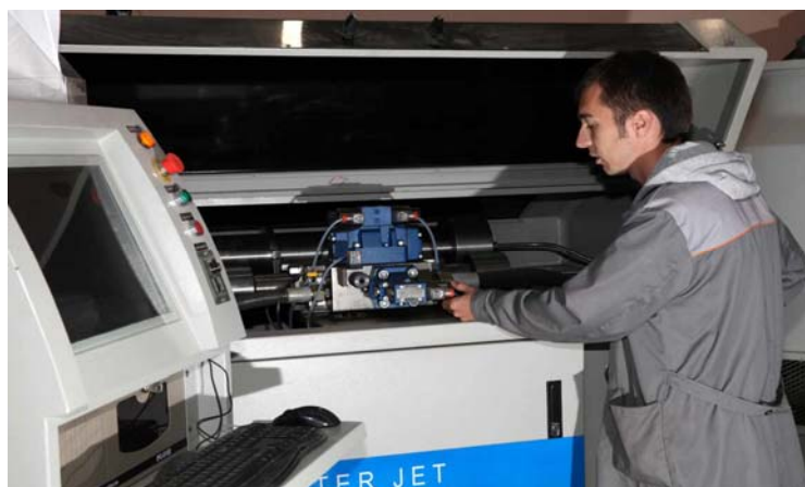
Сотрудник кафедры Смольников В. готовит к работе установку с ЧПУ для резки материалов водяной струей под давлением 3000 атм.
