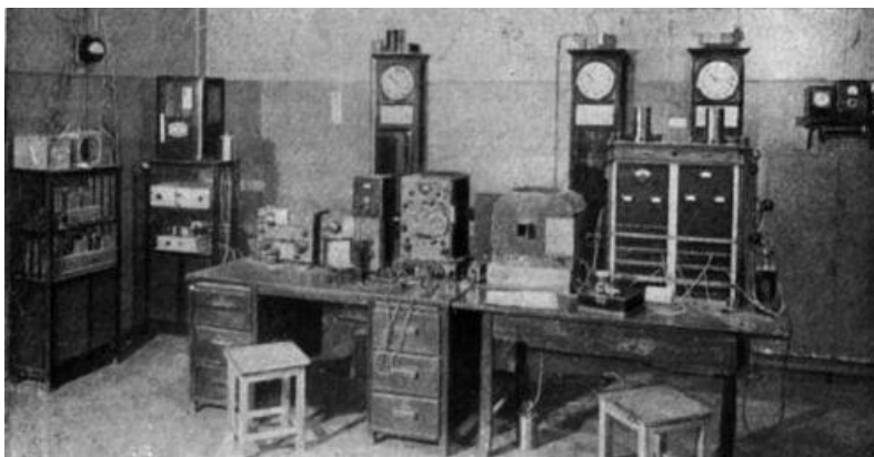
Аппаратная в Свердловске: стол с коммутатором, хроноскопами и приёмниками, сзади – вторичные часы Шорта, слева – звуковые генераторы
