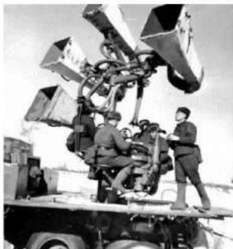
Советский звукоулавливатель ЗТ-5. 1941 год. Во время войны усовершенствован Ю.М. Сухаревским и Д.И. Блохинцевым
