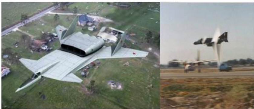
М-25 «Адский косильщик» конструкции В.М. Мясихева. На высоте 50 м величина избыточного давления в ударной волне могла достигать 0.22 \text{ кг/см}^2 . Уступ под фюзеляжем выпускался в боевом режиме
