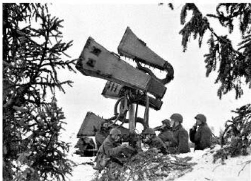
Советский звукоулавливатель ЗТ-5. 1941 год. Во время войны усовершенствован Ю.М. Сухаревским и Д.И. Блохинцевым
