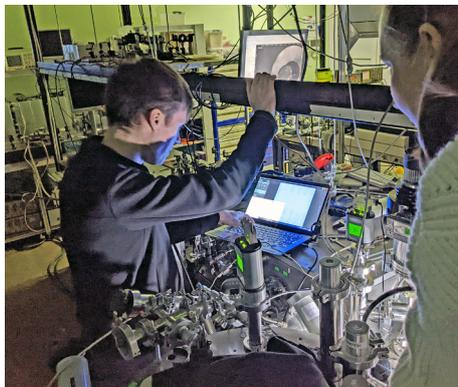
Рис. 3. Экспериментальный комплекс генерации когерентного излучения экстремального ультрафиолетового и мягкого рентгеновского диапазонов.
