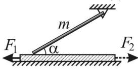
**18.I.1. Решение.** При движении доски влево на стержень действуют силы, модули и направления которых указаны на рисунке, где  $N$  – модуль нормальной составляющей силы реакции доски,  $F_{\text{тр}} = \mu N$  – модуль силы трения скольжения,  $mg$  – модуль силы тяжести ( $m$  – масса стержня),  $R$  – модуль силы реакции шарнира. Пусть  $l$  – длина стержня. Уравнение моментов, записанное относительно оси, проходящей через точку подвеса стержня (точку  $O$ ), имеет вид:
