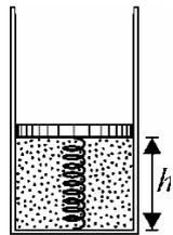
**22.П.2. Задача.** Невесомый поршень соединен с дном цилиндрического сосуда пружиной жесткостью  $k = 100$  Н/м. В сосуде под поршнем находится идеальный одноатомный газ, а над поршнем – вакуум. В начальном состоянии расстояние между поршнем и дном сосуда составляет  $h = 0,2$  м. Найдите количество теплоты  $\Delta Q$ , которое нужно сообщить газу, чтобы расстояние между поршнем и дном сосуда удвоилось. Считайте, что пружина не деформирована при  $h = 0$ .
