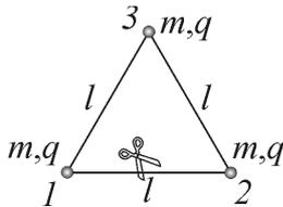
**19.III.1. Решение.** Поскольку силы взаимодействия между шариками являются внутренними и консервативными, в системе из трех шариков сохраняется импульс и полная механическая энергия. В проекции на ось  $OX$  закон сохранения импульса дает равенство  $mv_3 - mv_1 - mv_2 = 0$ . Так как массы шариков одинаковы, из закона сохранения импульса и из соображений симметрии следует, что  $v_1 = v_2 = \frac{v_3}{2}$ . Используя формулу для
