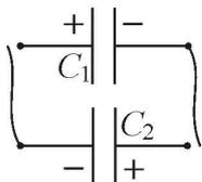
**18.III.2. Задача.** Разность потенциалов между обкладками конденсатора ёмкостью  $C_1 = 1$  мкФ равна  $V_1 = 20$  В. Второй конденсатор ёмкостью  $C_2 = 3$  мкФ заряжен до разности потенциалов между обкладками  $V_2 = 10$  В. Разноименно заряженные пластины этих конденсаторов соединили проводниками. Определите, во сколько раз  $k$  при этом изменилась общая энергия конденсаторов.
