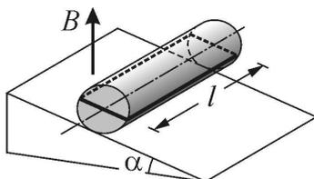
**19.III.2. Задача.** Деревянный цилиндр массой  $m = 25$  г и длиной  $l = 10$  см лежит на наклонной плоскости, образующей с горизонтом угол  $\alpha = 30^\circ$ , так, что ось цилиндра горизонтальна. Цилиндр плотно (без зазора)
