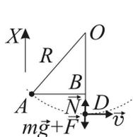
$\frac{mv^2}{2} - mgH = q(\varphi_A - \varphi_D)$ , где  $\varphi_A$  и  $\varphi_D$  – потенциалы, создаваемые неподвижным зарядом  $q$  в точках  $A$  и  $D$ . Из геометрических соображений следует, что  $\triangle ABO$  – прямоугольный треугольник со сторонами  $AO = 5H$ ,  $OB = 4H$ ,  $BA = 3H$ , поэтому  $\varphi_A = \frac{kq}{3H}$ ,  $\varphi_D = \frac{kq}{H}$ ,
