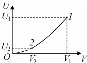
**15.П.1. Задача.** Какую работу  $A$  надо совершить для сжатия некоторого количества идеального одноатомного газа в  $k = 3$  раза, если внутренняя энергия газа  $U$  меняется при этом так, как показано на рисунке? Участок  $1-2$  – отрезок параболы с вершиной в начале координат. Исходное значение внутренней энергии газа равно  $U_1 = 135$  кДж.
