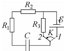
**15.Ш.3. Задача.** В цепи, схема которой изображена на рисунке, ключ  $K$  сначала достаточно долго удерживали в положении 1. Затем ключ перевели в положение 2. Известно, что после этого на сопротивлении  $R_1$  выделилось количество теплоты  $Q_1 = 1$  мДж. Определите ЭДС  $\mathcal{E}$  источника. При расчетах примите  $R_1 = 100$  Ом;  $R_2 = 200$  Ом;  $R_3 = 300$  Ом;  $C = 120$  мкФ.
