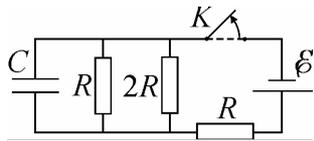
**15.Ш.2. Решение.** Сопротивление цепи при замкнутом ключе  $K$  равно  $\frac{5R}{3}$ . Поэтому до размыкания ключа сила тока, протекающего через источник, равна  $I = \frac{3\mathcal{E}}{5R}$ ,
