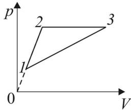
которого изображена на рисунке. В процессе  $1-2$  объём газа возрастает в  $n=2$  раза, а в процессе  $2-3$  объём дополнительно возрастает ещё в  $k=3$  раза. Найдите коэффициент полезного действия (КПД) тепловой машины, работающей по указанному циклу.
