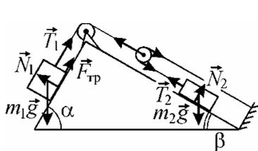
$m_{1,2}\vec{g}$  – силы тяжести,  $\vec{N}_{1,2}$  – нормальные составляющие сил реакции призмы,  $\vec{T}_{1,2}$  – силы натяжения нитей,  $\vec{F}_{\text{тр}}$  – сила трения скольжения. По второму закону Ньютона имеем:  $m_1 a_1 = m_1 g \sin \alpha - T_1 - \mu m_1 g \cos \alpha$  (для левого груза),  $m_2 a_2 = T_2 - m_2 g \sin \beta$  (для правого груза). Кроме того,
