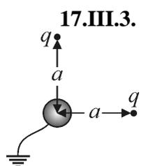
**17.Ш.3. Задача.** Два одинаковых точечных заряда  $q = 10^{-7}$  Кл находятся на расстояниях  $a = 1$  м от центра заземлённой проводящей сферы радиуса  $R = 5$  см (рисунок). Отрезки, проведённые из центра сферы к зарядам, взаимно перпендикулярны. Расстояния от зарядов и сферы до окружающих тел достаточно велики. Определите модуль  $F$  силы, с которой заряды действуют на сферу. Электрическая постоянная  $\epsilon_0 = 8,85 \cdot 10^{-12}$  Ф/м.
