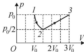
**19. II. 2. Задача.** Над некоторым количеством идеального одноатомного газа осуществляют процесс, представленный на графике, где участок  $1 - 2$  — адиабатное расширение. Найдите отношение  $\eta$  работы, совершенной газом, к количеству теплоты, полученному газом от нагревателя.
