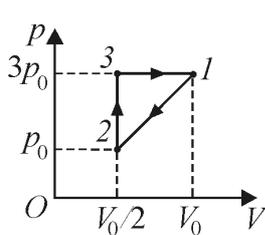
уравнений  $p_0 = b + \frac{k}{2\rho_0}$ ,  $3p_0 = b + \frac{k}{\rho_0}$  находим, что  $b = -p_0$ ,  $k = 4p_0\rho_0$  и  $p = p_0\left(-1 + 4\frac{\rho_0}{\rho}\right)$ , или  $p = p_0\left(-1 + 4\frac{V_0}{V}\right)$ , где  $V_0$  –
