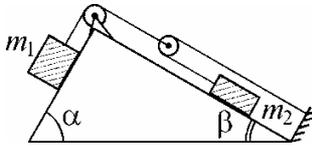
Правая грань призмы гладкая, левая – шероховатая с коэффициентом трения  $\mu = 0,6$ . Определите модуль ускорения левого груза  $a_1$ . Углы при основании призмы  $\alpha = 60^\circ$ ,  $\beta = 30^\circ$ . Ускорение свободного падения примите равным  $g = 10$  м/с<sup>2</sup>.
