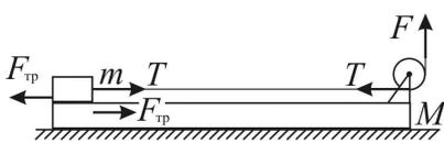
во всех её точках и равна по модулю силе  $F$ . Силы, действующие на доску и брусок, указаны на рисунке. В проекции на горизонтальное направление второй закон Ньютона для бруска и доски
