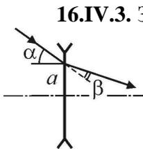
**16.IV.3. Задача.** На поверхность тонкой рассеивающей линзы падает луч света на расстоянии  $a = 1$  см от центра линзы под углом  $\alpha = 0,1$  рад к ее главной оптической оси. Найдите модуль фокусного расстояния линзы  $f$ , если вышедший из линзы луч отклоняется от первоначального направления на угол  $\beta = 0,05$  рад. Учтите, что для малых значений аргумента  $x$ ,
