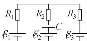
сопротивления резисторов  $R_1 = R_2 = R_3 = 10$  Ом, емкость конденсатора  $C = 2$  мкФ, ЭДС источников  $\mathcal{E}_1 = 10$  В,  $\mathcal{E}_2 = 8$  В,  $\mathcal{E}_3 = 5$  В, их внутренние сопротивления пренебрежимо малы. Найдите заряд  $q$  на пластинах конденсатора.
