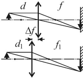
**IV.5. Решение.** Линейное увеличение, даваемое линзой,  $\Gamma = \frac{f}{d}$ , откуда  $d = \frac{\Gamma}{f}$ . Здесь  $d$  – расстояние от диапозитива до линзы, а  $f$  – расстояние от линзы до экрана. Из формулы тонкой линзы оптическая сила линзы  $D = \frac{1}{d} + \frac{1}{f} = \frac{1}{f}(\Gamma + 1)$ . По условию, оптическая сила остается неизменной, но изменяется расстояние
