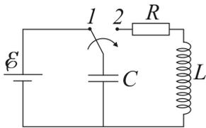
ёмкостью  $C = 1$  мкФ сначала заряжается от источника с ЭДС  $\mathcal{E} = 10$  В. Затем ключ переводят в положение 2. Какое количество теплоты  $Q_L$  выделится за всё время возникших затухающих колебаний на катушке, если она изготовлена из медной проволоки длиной  $l = 10$  м и сечением  $S = 1$  мм<sup>2</sup>. Сопротивление резистора  $R = 1,7$  Ом. Удельное сопротивление меди примите равным  $\rho = 1,7 \cdot 10^{-8}$  Ом·м.
