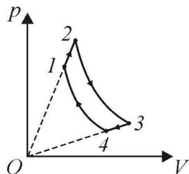
**16.П.2. Задача.** Над идеальным газом проводится циклический процесс, состоящий из двух участков  $1-2$ ,  $3-4$ , на которых давление пропорционально объему, и двух адиабат  $2-3$ ,  $4-1$  (см. рисунок). Известно, что изменение температуры газа на участке  $1-2$  равно  $\Delta T_1 = 20$  К, а модуль изменения температуры на участке  $3-4$  равен  $\Delta T_2 = 15$  К. Найдите коэффициент полезного действия цикла  $\eta$ .
