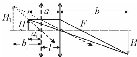
**15.IV.2. Решение.** Построение действительного изображения  $I$  и мнимого изображения  $I_1$  предмета  $\Pi$  показано на рисунке. Для исходного положения линзы использованы сплошные линии, для смещенного – штриховые. Используя обозначения, приведенные на рисунке, по формуле тонкой линзы
