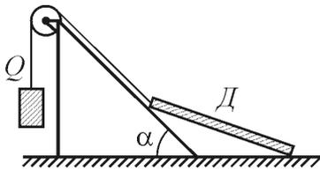
конце нити подвешен груз  $Q$ . Отрезок нити между дощечкой  $D$  и блоком параллелен наклонной плоскости, а между грузом  $Q$  и блоком – вертикален. Определите коэффициент трения  $\mu$  дощечки о наклонную плоскость, зная, что равновесие системы нарушается, если вес груза  $Q$  превышает  $5 \text{ Н}$ . Числовой ответ округлите до двух значащих цифр.
