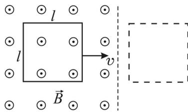
**22.III.2. Задача.** Квадратная проволочная рамка со стороной  $l = 30$  см помещена в однородное магнитное поле, линии индукции которого направлены перпендикулярно плоскости рамки. Модуль вектора магнитной индукции равен  $B = 1$  Тл, поле имеет резко очерченную границу, параллельную стороне рамки (см. рисунок). Каково сопротивление рамки  $R$ , если при её выдвигании с постоянной скоростью  $v = 5$  м/с из области с магнитным полем в ней выделяется количество теплоты, равное  $Q = 90$  мДж?
