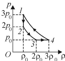
**17.П.5. Задача.** Идеальный одноатомный газ совершает в тепловом двигателе цикл  $1-2-3-4-1$ , в котором давление  $p$  газа изменяется с изменением его плотности  $\rho$  так, как показано на рисунке, причём графики процессов  $2-3$  и  $4-1$  представляют собой участки гипербол. Определите коэффициент полезного действия (КПД) цикла  $\eta$ . Ответ приведите в процентах, округлив до одного знака после запятой.
