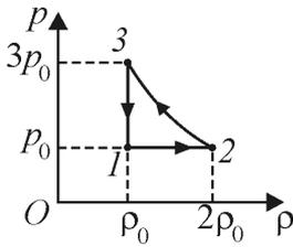
**17.П.3. Решение.** Согласно условию, на участке  $2-3$  зависимость давления газа от его плотности описывается законом вида  $p = b + \frac{k}{\rho}$ . Из системы
