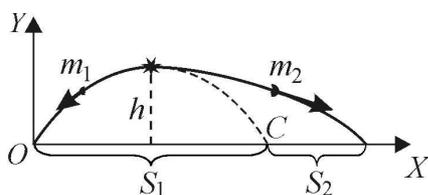
была бы равна  $S_1 = \frac{v_0^2}{g} \sin 2\alpha$ . (см. штриховую линию на рисунке). Здесь  $v_0$  – начальная скорость снаряда.
