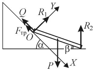
пластины можно представить в виде  $-Q - F_{\text{тр}} - R_2 \sin \alpha + P \sin \alpha = 0$ ,  $R_1 + R_2 \cos \alpha - P \cos \alpha = 0$ , а отсутствие углового ускорения пластины относительно оси, проходящей через точку  $O$ , в виде:  $R_2 l \cos \beta - P \frac{l}{2} \cos \beta = 0$ .
