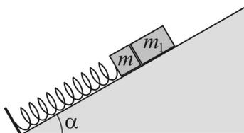
$\alpha = 30^\circ$ . Жёсткость пружины  $k = 200$  Н/м. Модуль ускорения свободного падения считайте равным  $g = 10$  м/с<sup>2</sup>.
