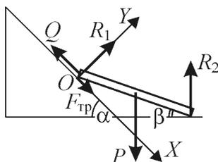
покоится, то условие отсутствия ускорения у центра масс дощечки можно представить в виде:  $-Q + F_{\text{тр}} - R_2 \sin \alpha + P \sin \alpha = 0$ ,  $R_1 + R_2 \cos \alpha - P \cos \alpha = 0$ , а отсутствие углового ускорения дощечки относительно оси, проходящей через точку  $O$ , в виде:  $R_2 l \cos \beta - P \frac{l}{2} \cos \beta = 0$ . Здесь  $Q$  – модуль силы,
