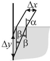
**16.IV.2. Решение.** Ход луча, преломленного на границе раздела воздуха и воды, изображен на рисунке при двух положениях источника. Видно, что горизонтальное перемещение  $\Delta x$  источника и вертикальное перемещение  $\Delta y$  светлого пятна на стенке бассейна связаны соотношением  $\Delta y = \frac{\Delta x}{\operatorname{tg} \beta}$ , где  $\beta$  – угол преломления. По закону преломления  $\sin \beta = \frac{\sin \alpha}{n}$ .
