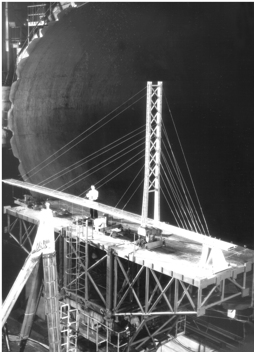
Исследование средств уменьшения ветровых нагрузок на динамически подобной модели вантового моста через р. Обь (г. Сургут) в аэродинамической трубе ЦАГИ Т-101 (ось эллипса рабочей части 24 м), 1998 г.
