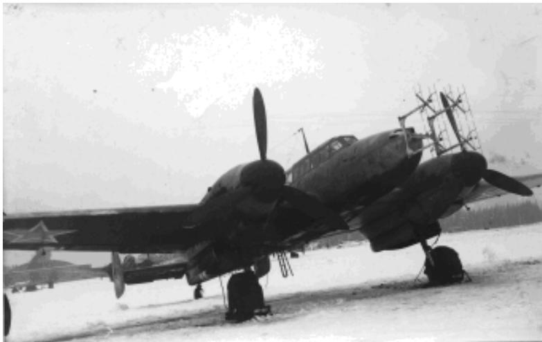
Один из экспериментальных образцов радионавигационного обу-
