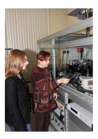
Профессор, д.ф.-м.н. Казей З.А. и студентка 4 курса Вялых Д. монтируют образец для исследования на автоматизированном дифрактометре STADIIP с низкотемпературной приставкой замкнутого цикла, работающей в области температур 6...300 К.
