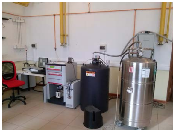
Установка для исследования термодинамических свойств (Physical Property Measuring System (PPMS), Quantum Design) в диапазоне температур 0.3-300 K.
