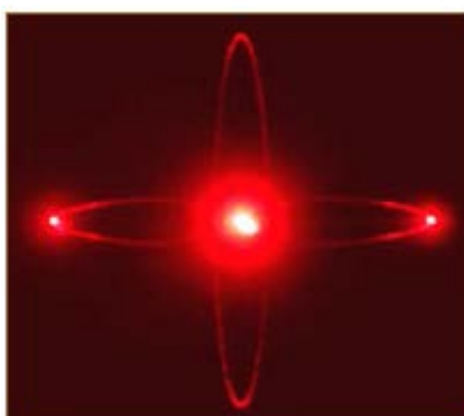
Диаграмма Шеффера-Бергмана — анизотропия скорости звука в кристалле в лазерном свете
