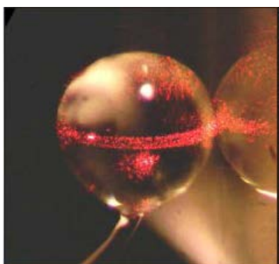
Микрорезонатор из кварца с добротностью 10^9 . Изготовлен в лаборатории М.Л.Городецкого
