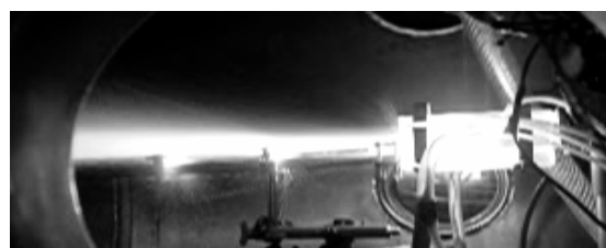
Рис. 15. Стабилизация горения высокоскоростного пропан-воздушного потока в условиях программированного СВЧ-разряда
