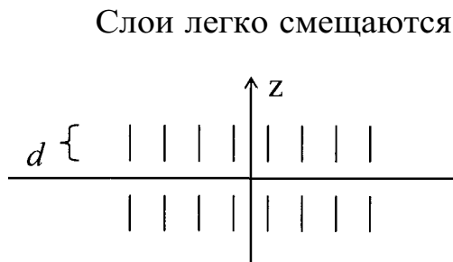
Рис.11. Схема расположения молекул в слоях смектического кристалла типа А
