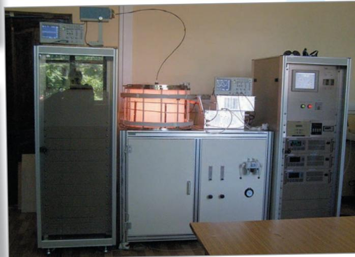
*Уникальный высокочастотный плазмохимический реактор диаметром 450 мм с высокой степенью однородности плазмы, достигаемой сложной комбинацией магнитных и электрических полей.*
