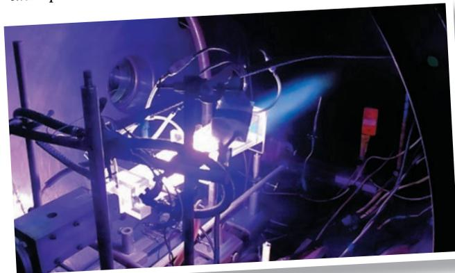
*Модель сверхзвукового прямоточного двигателя.*
